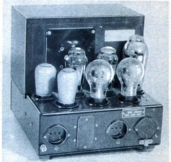
Der Philips-Verstärker Nr. 3756 vereinigt die Vorteile der A- und B-Verstärkung durch einen genialen Schaltungskniff. (Werkphoto)
